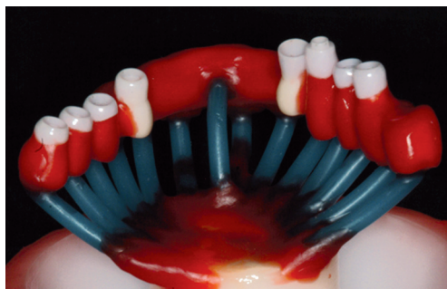
Fig. 23. La maquette en cire est disposée sur le cône d'injection d'un cylindre de 300 g.
