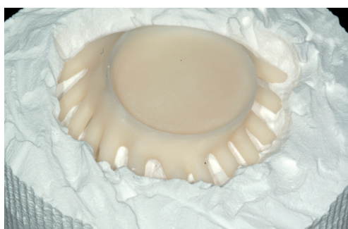
Fig. 25. À l'issue de la pressée et après complet refroidissement, les tiges de coulées doivent être impérativement sectionnées lorsque la pièce est encore dans le revêtement, sous peine de voir celle-ci se fracturer à cause des très grandes tensions induites par la masse réfractaire.
