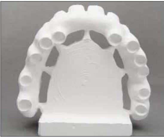
Abb. 10 und 11 Das in Zirkoniumdioxid umgesetzte „Monster“ mit einer definitiven Höhe von 22 mm. In Fällen wie diesen ist darauf zu achten, dass der Zirkoniumdioxidblock nicht zu weit oben oder unten in die Scheibe des Pantographen geklebt wird
