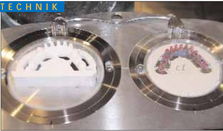
Abb. 3 Die schwenkbaren und drehbaren Aufnahmetische des Pantographen ermöglichen es uns, jede Implantatachse zu finden und zu durchbohren. Die Anzahl der Implantate ist dabei unerheblich
