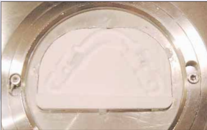
Abb. 24 Deutlich ist hier zu erkennen, wie das Modellgussanalog aus dem Zirkoniumdioxidblock „herausgezaubert“ wird
