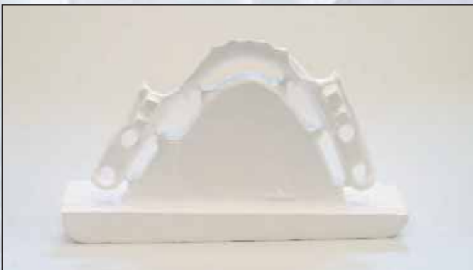
Abb. 26 Nun liegt alles weitere in unseren Händen. Nach dem vorsichtigen Glätten der ungesinterten Konstruktion, wird die Arbeit mitsamt Block gesintert. Dadurch umgehen wir die Gefahr eines eventuell auftretenden Verzugs. Hierauf muss allerdings nur beim Sinterbrand geachtet werden. Die gesinterte Struktur ist dimensionsstabil – egal wie oft Sie brennen
