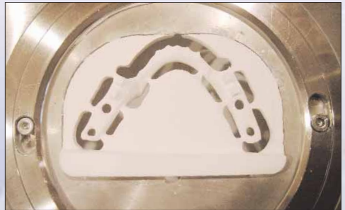
Abb. 25 Die Konstruktion ist fertig gefräst. Sie kann jetzt aus dem Pantographen entfernt werden
